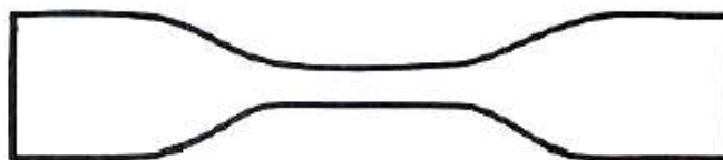
Obr. 31: Zkušební tělísko pro tahovou zkoušku
