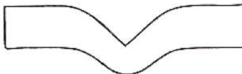
Obr. 34: Zkušební tělísko pro zkoušku strukturní pevnosti
