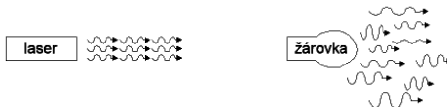
Obr. 5. Srovnání světla vyzařovaného laserem se světlem žárovky (10)
