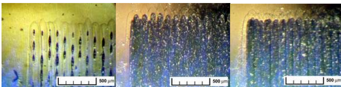
Obr. 33, 34, 35. Parametry obrábění: výkon 10 %, 20 %, 30 %, posuv 100 %, vzorek č. 6
