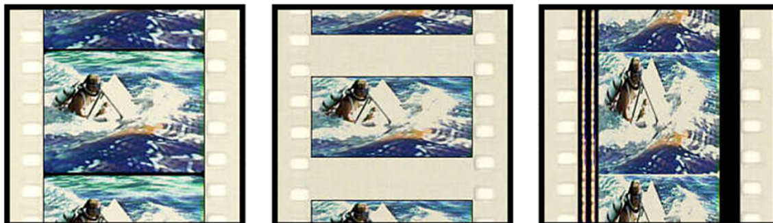
Obr.15. Superscope 235. 1. Obrázek je rovnou z kamery. 2. Obrázek po vymaskování obrazu v laboratoři a 3. Obrázek je anamorfotická kopie pro kina.
