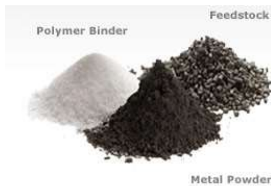
Obr. 42. Feedstock zložený z polymérneho spojiva a prášku kovu [13]
