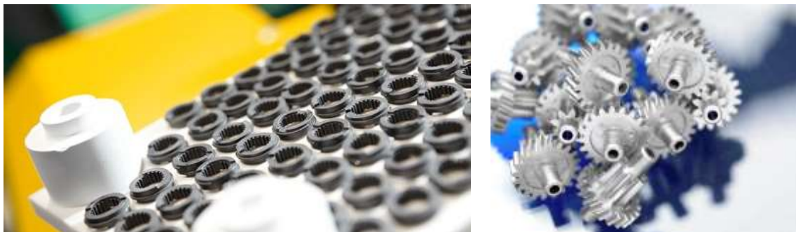
Obr. 41. Výroba malých a zložitých súčastí PIM technológiou [11]
