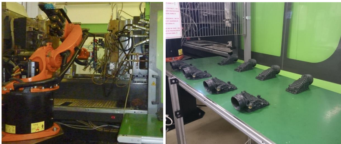
Obr. 28 Robot Kuka vyndávající díly z formy na pohyblivý pás (vlastní zpracování)
