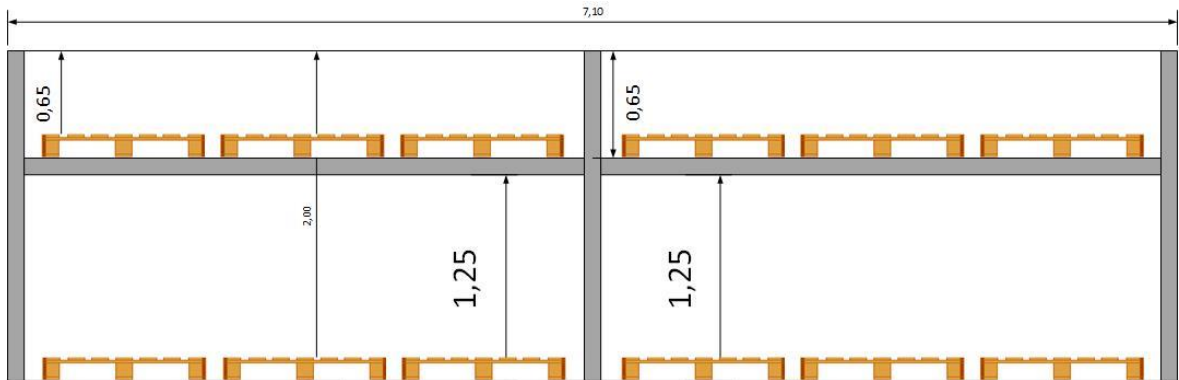
Obr. 29 Návrh regálu pro materiál uvolněný do výroby 1 (vlastní zpracování)
