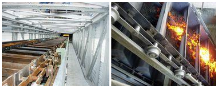
Obr. 12. Kombinace dopravníků článkového a korečkového [7]
