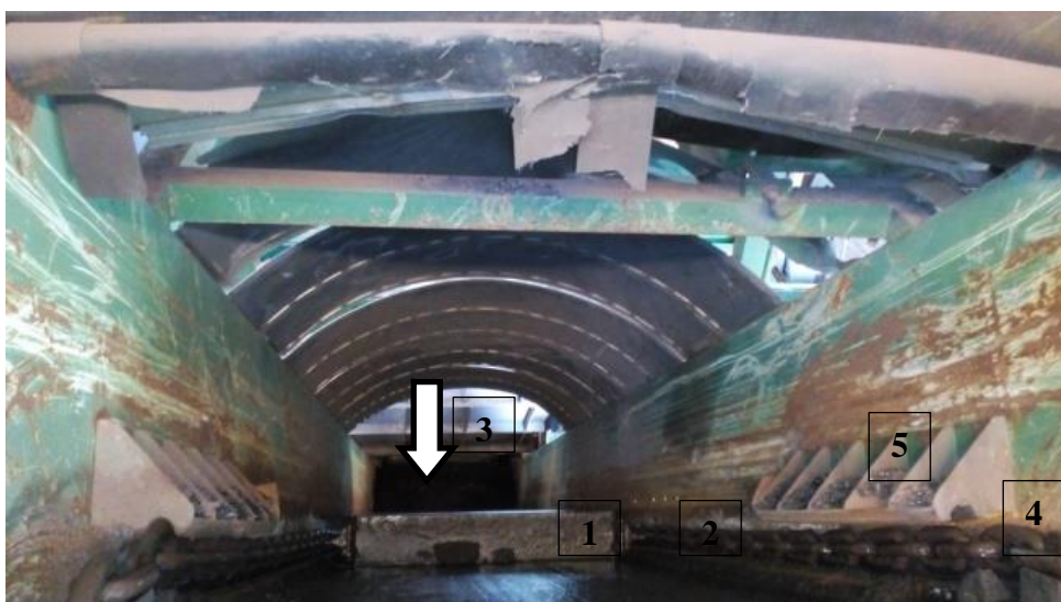
Obr. 21. Vynášecí větev dopravníku strusky
