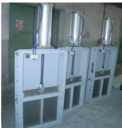
Obr. 17. Šoupátkový uzávěr s pneumatickým pohonem [5]
