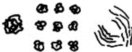
Obr. 2-4 Nadmolekulární struktura amorfních plastů.[16]
