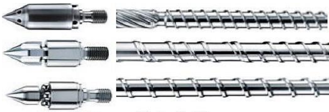
Obr. 1-8 Příklady zpětných uzávěrů (vlevo) a příklady šneků (vpravo).[12]
