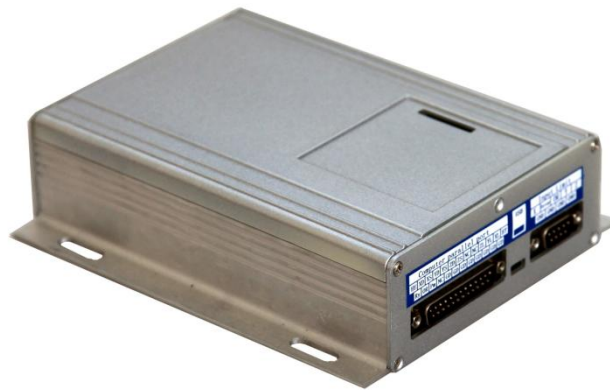
Obr. 34. Driverová deska pro řízení 3 krokových motorů do 5A [36]
