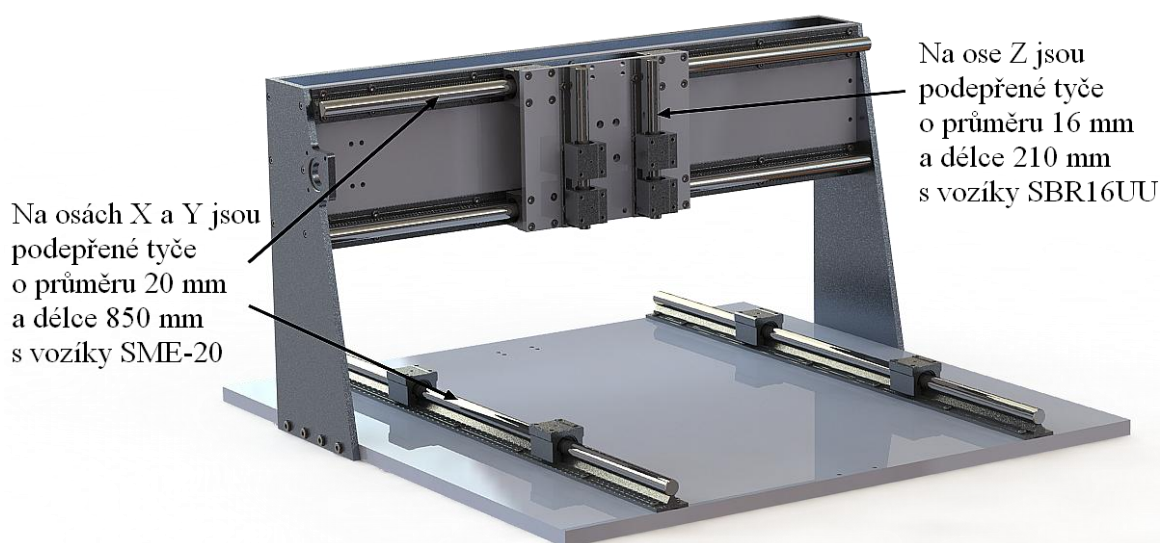
Obr. 24. Konstrukční návrh umístění podepřných tyčí s vozíky
