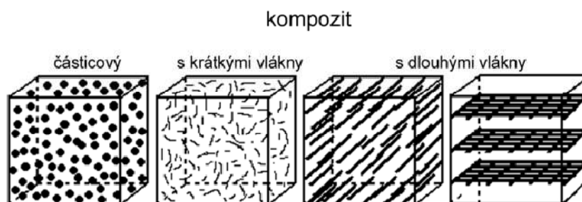
Obr. 2- Rozdělení podle geometrického tvaru výztuže [2]
