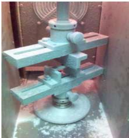
Obr. 13- Metoda třibodového ohybu [15]
