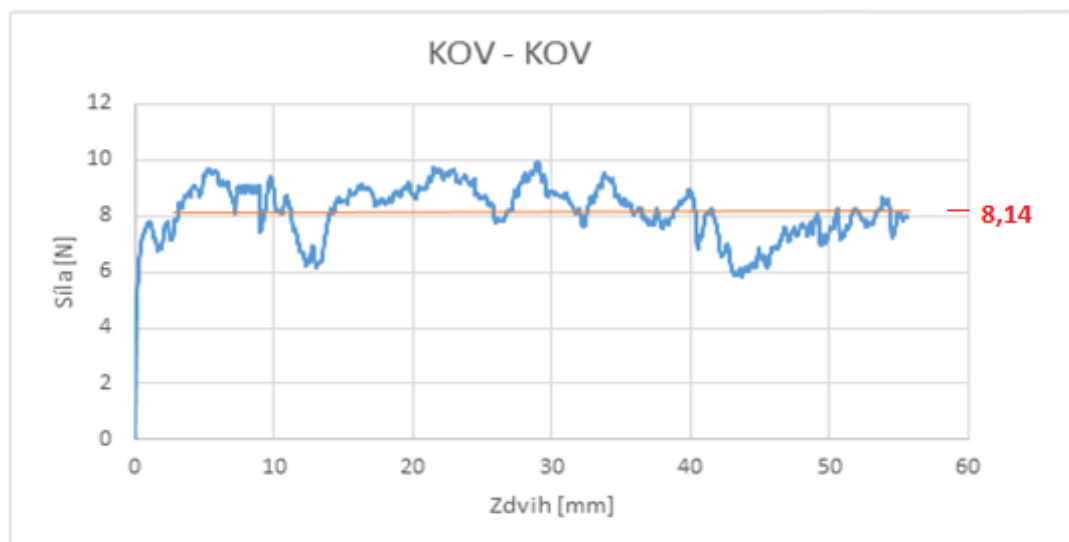
Obrázek 35: Graf závislosti posouvající síly a zdvihu pro vzorek kov - kov
