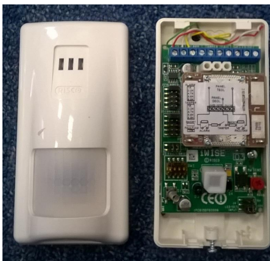
Obr. 15 Příklad duální detektor PIR+MW [foto autor]
