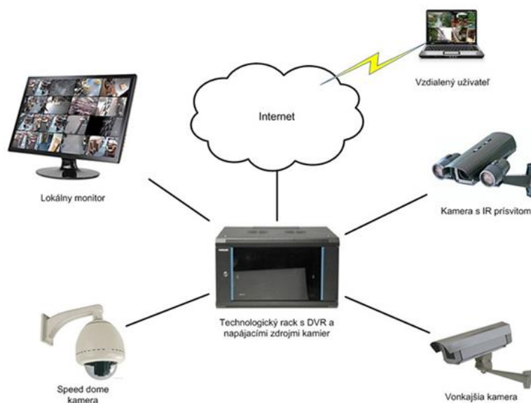
Obr. 20 Blokové schéma CCTV [20]
