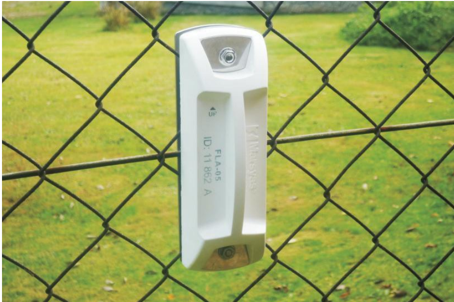
Obr. 37 Akcelerační RFID tag [6]
