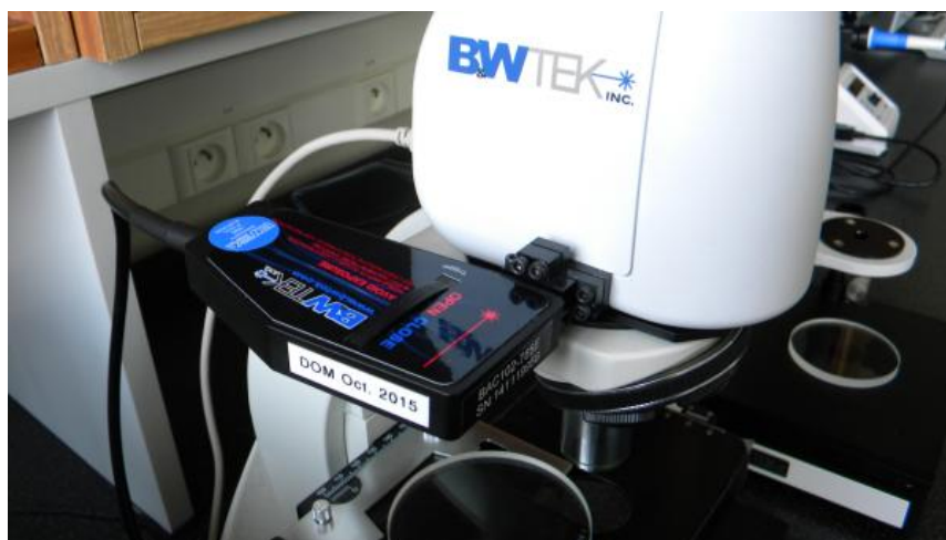
Obr. 16: Sonda připojená ke kameře mikroskopu. Foto autor.
