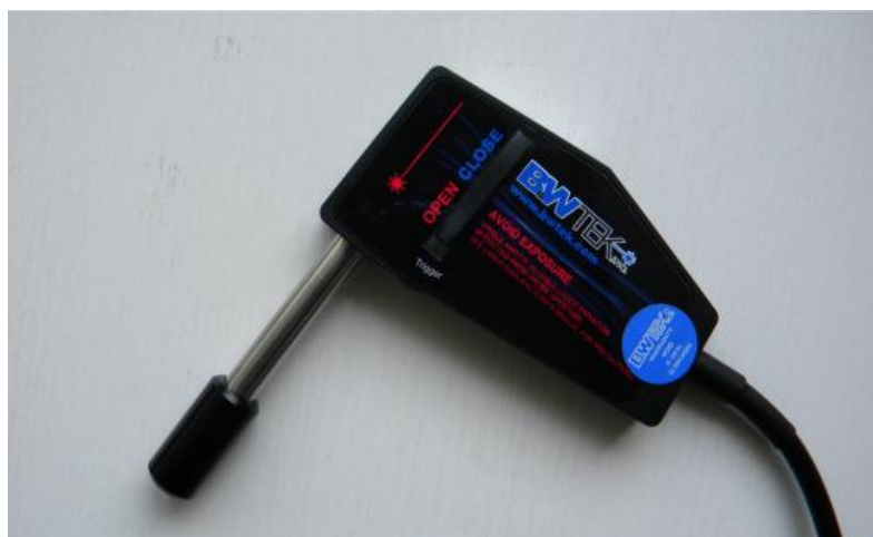
Obr. 17: Sonda s dlouhým adaptérem a distanční koncovkou. Foto autor.
