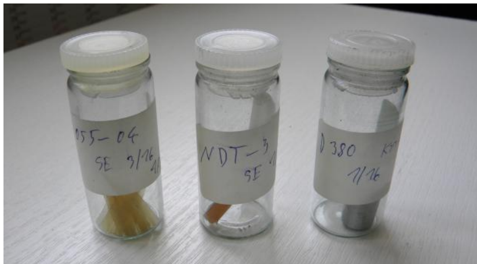
Obr. 20: Vzorky střelivin. Zleva: D 055, NDT – 3 a D 380. Foto autor.
