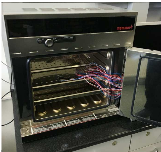
Obr. 27 – Obrázek univerzální pece Memert UNP 200, uvnitř se nachází měřené vzorky
