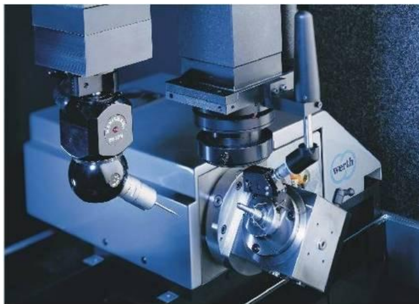
obr. 38: pracovní prostor multisenzorového měřicího přístroje [22]
