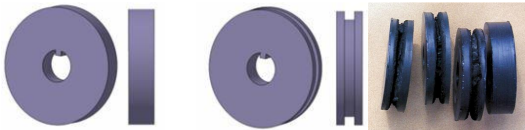
Obr. 25. Zkušební těleso pro zkoušku rychlého opotřebení [13]
