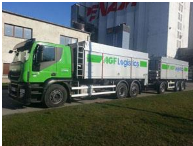
Obr. 3. Speciální souprava na přepravu a vyskladnění krmné směsi do sil (vlastní zpracování)
