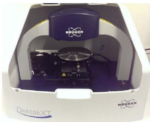
Obrázek 15 – Použitý profilometr DektaXT od společnosti Bruker.
