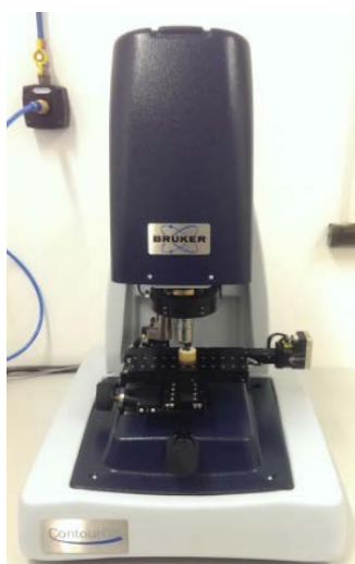
Obrázek 16 – Použitý bezkontaktní profilometr Contour GT od společnosti Bruker.
