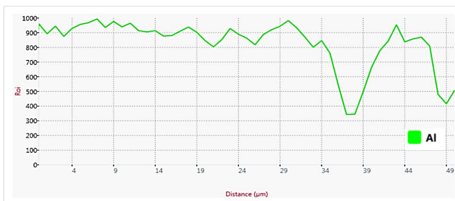
Obrázek 17 – Prvkové složení použitého materiálu určené pomocí SEM-EDAX analýzy na Elektronovém mikroskopu FEI Nova NanoSEM 450.
