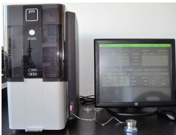
Obrázek 14 – Použitý skenovací elektronový mikroskop Phenom Pro.
