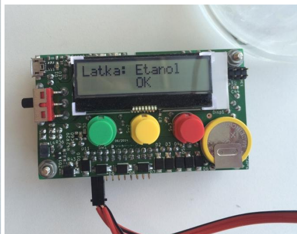
Obr. 70 – Zařízení na vyhodnocování organických par, a) při vlastním vyhodnocování, b) zobrazení vyhodnoceného rozpouštědla
