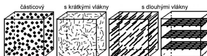
Obr. 11 – Typy kompozitů podle tvaru částic a jejich uspořádání [25]
