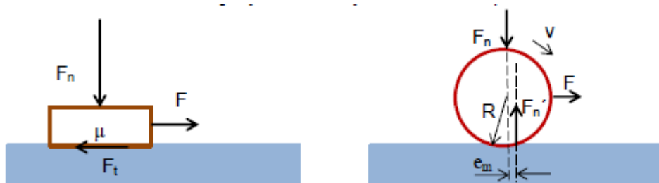
Obrázek 1: Znázornění kluzného a valivého tření. [14]
