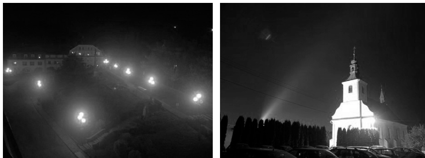
Obr.9. a Obr.10 Příklady chybné instalace architektonického osvětlení
