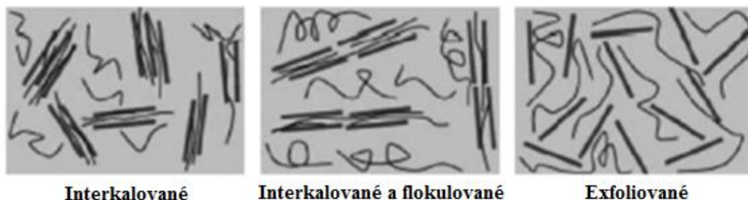
Obr. 16 Schéma možných morfologických uspořádání polymeru obsahující jílu [31]
