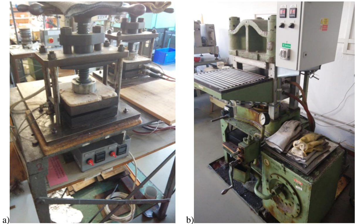
Obr. 28 a) Lis mechanický, b) lis hydraulický
