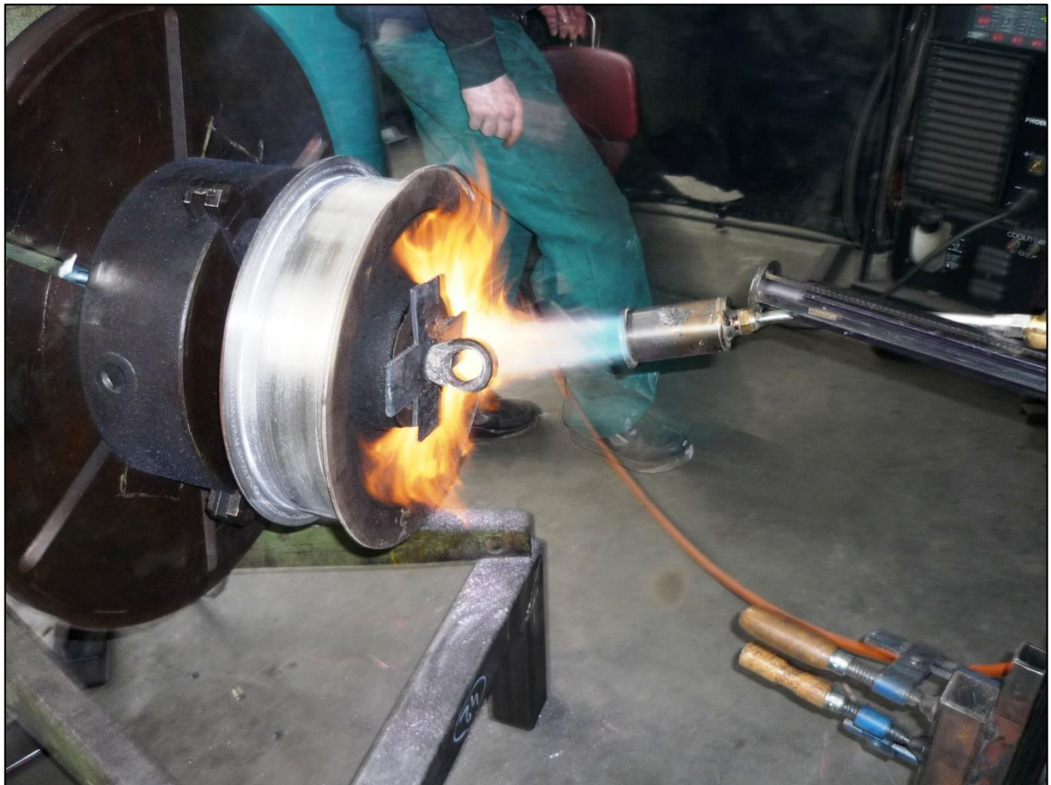
Obrázek 22: Předehřev pomocí propan- butanového hořáku
