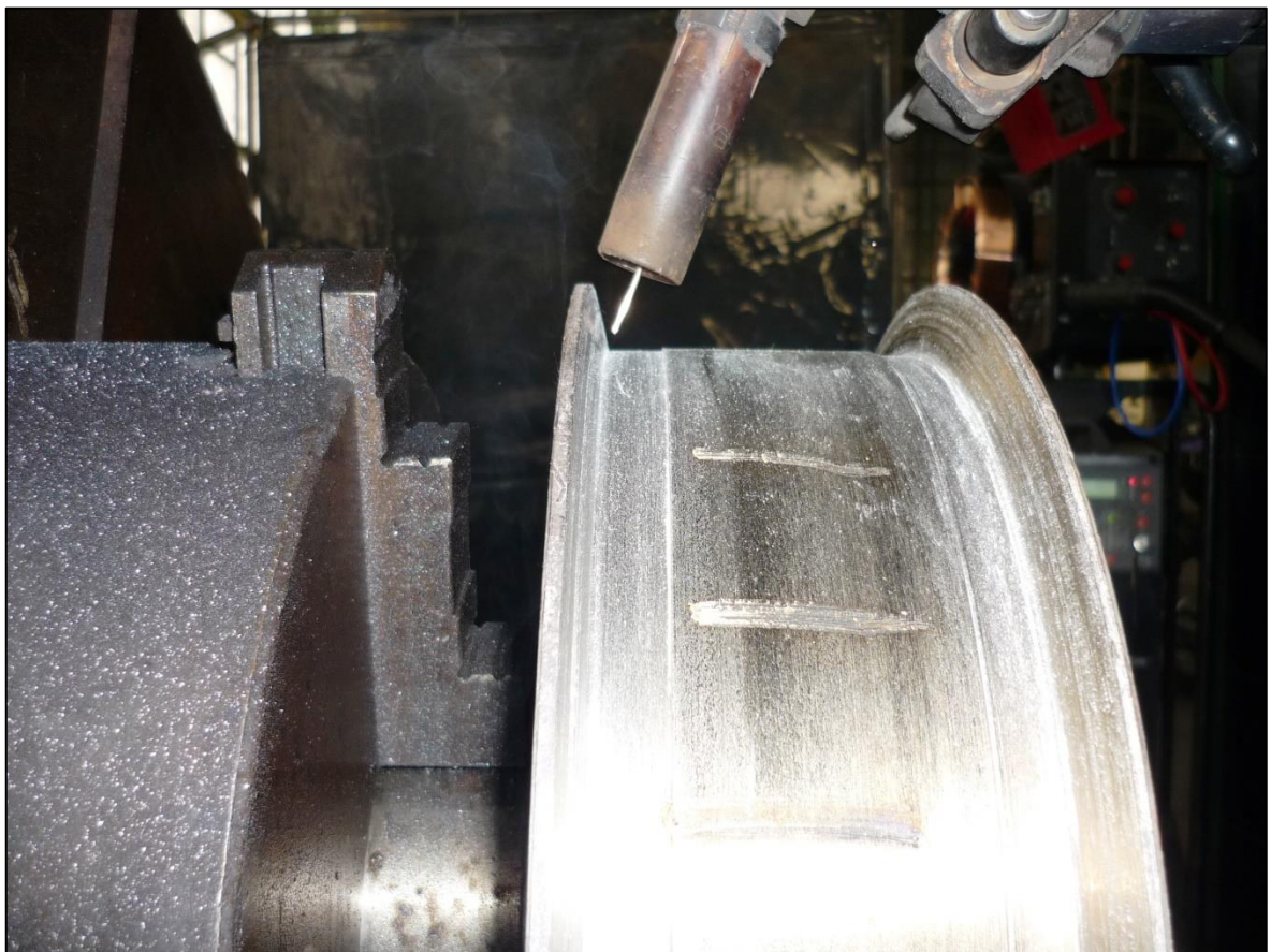
Obrázek 27: Kolo upnuté v polohovadle a hubice se špičkou nastaveny pro aplikaci úvodní svarové housenky
