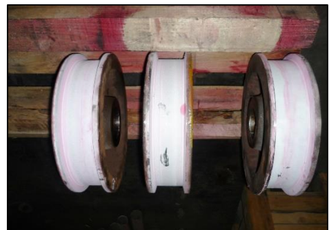
Obrázek 18: Kola č. 1, 2, 4 po provedení PT
