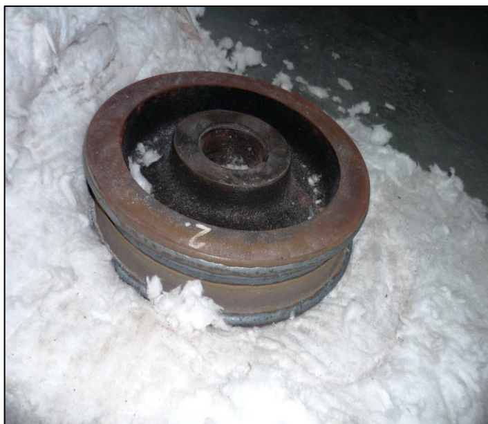
Obrázek 33: Součástka po rozbalení izotermického zábalu
