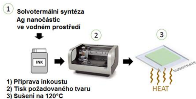
Obr. 23.: Proces inkoustového tisku flexibilní antény na PET substrát.
