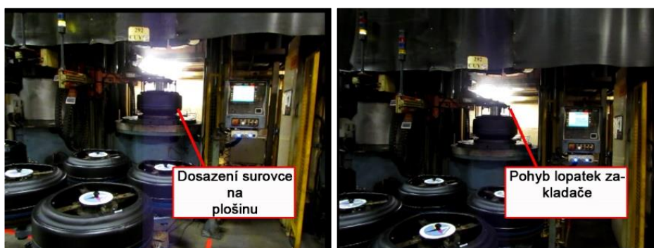
Obrázek 39 – Fáze bombírování (vlastní zpracování)
