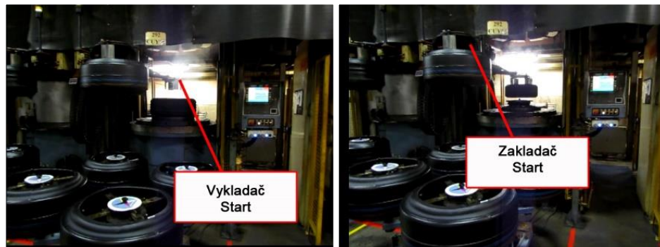
Obrázek 36 – Kompletní pohyb vykladače (Vlastní zpracování)
