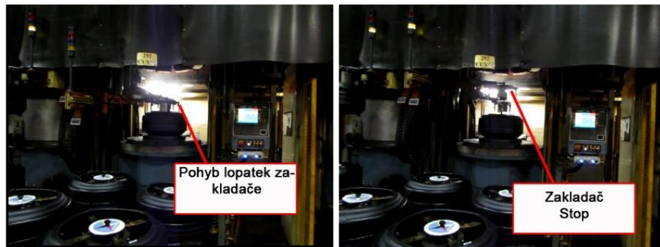
Obrázek 40 – Počátek fáze pohybu zakladače nahoru (vlastní zpracování)
