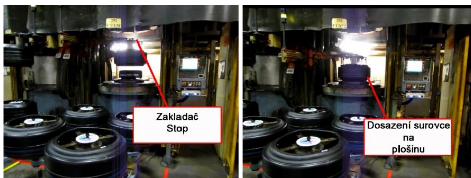
Obrázek 38 – Fáze pohybu membrány nahoru + dolů (vlastní zpracování)
