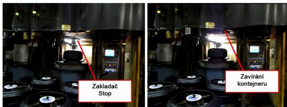
Obrázek 41 – Počátek fáze pohybu zakladače mimo lis (vlastní zpracování)
