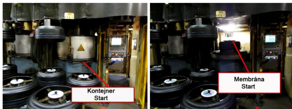
Obrázek 33 – Fáze otevření kontejneru (Vlastní zpracování)
