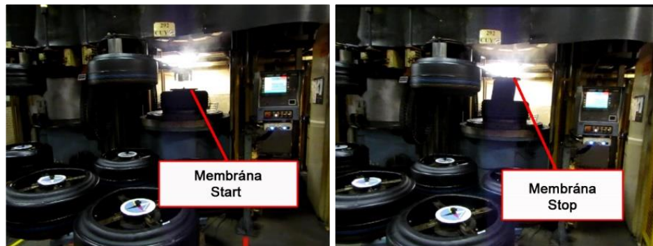
Obrázek 34 – Fáze vyjetí membrány (vlastní zpracování)
