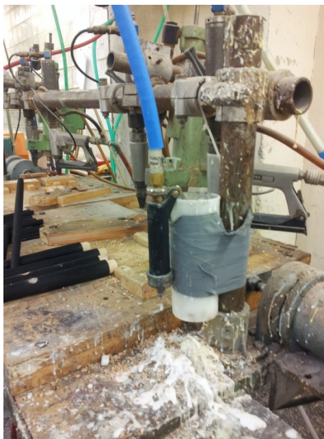
Obrázek 49 – Manuální dávkovač lepidla (vlastní zpracování)
