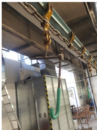
Obrázek 31 – Poškozený hák závěsného dopravníku (vlastní zpracování)
