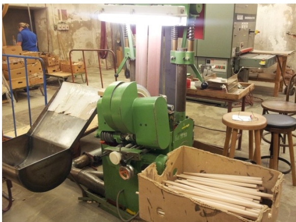
Obrázek 45 – Broušení prutů (vlastní zpracování)
