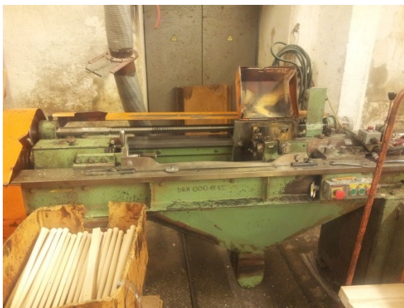
Obrázek 43 – Soustružení prutů (vlastní zpracování)
