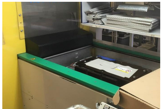
Obrázek 18 Svařování rámečku s PVC folií, vlastní pracování
