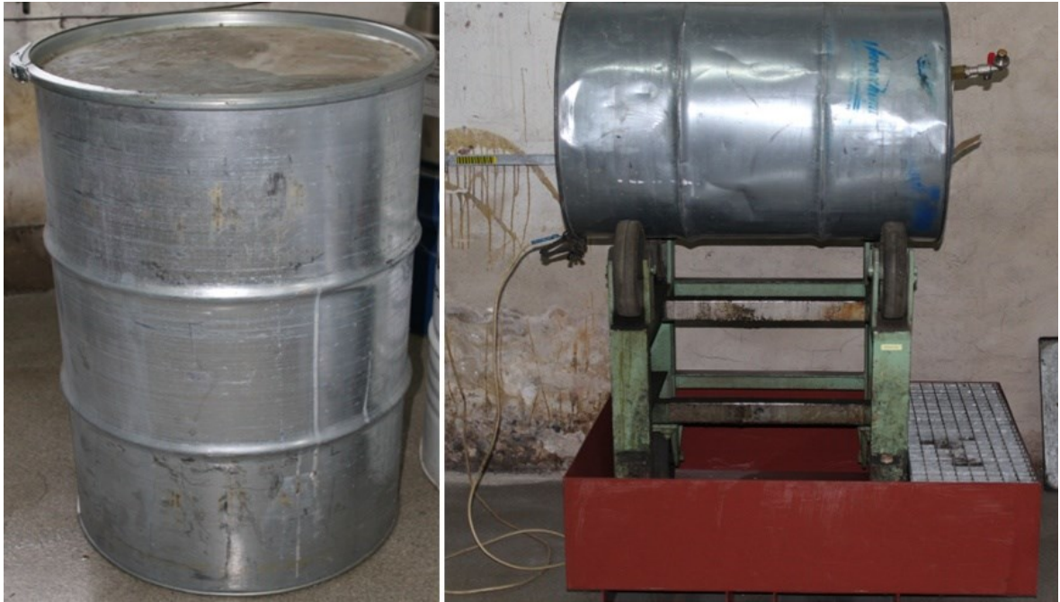
Obr. 22 Sudy a sudový stojan so záchytnou vaničkou (vlastné spracovanie)
