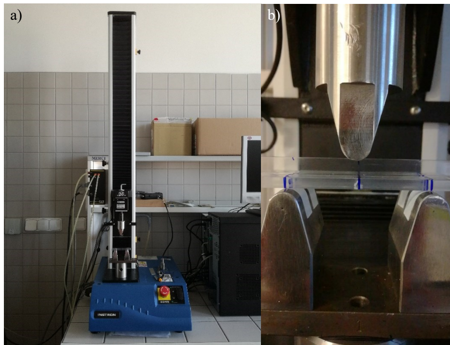
Obr. 17 – Cyklický tříbodový ohyb: a) Instron 3345, b) detail podpěr, zábran, vzorku a zátěžového tělesa
