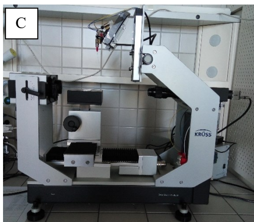
Obr. 11 – použité přístroje pro charakterizaci připravených vzorků: A – skenovací elektronový mikroskop Phenom Pro; B – kontaktní profilometr DiaVite DH-8; C – přístroj pro měření kontaktního úhly smáčení Krüss Drop Shape Analyzer DSA30; D – mikroskop atomárních sil NTEGRA Prima od firmy NT-MDT
