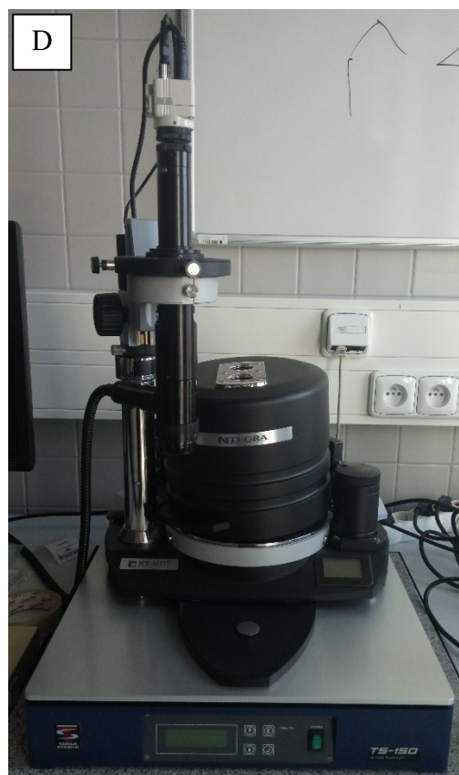
Obr. 11 – použité přístroje pro charakterizaci připravených vzorků: A – skenovací elektronový mikroskop Phenom Pro; B – kontaktní profilometr DiaVite DH-8; C – přístroj pro měření kontaktního úhly smáčení Krüss Drop Shape Analyzer DSA30; D – mikroskop atomárních sil NTEGRA Prima od firmy NT-MDT
