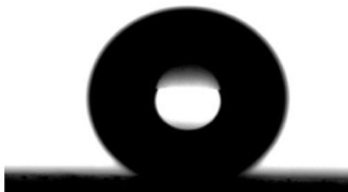
Obr. 9 – vzhled kapky vody na povrchu hliníku upraveném pomocí chemického leptání a následné depozici kyseliny stearové se statickým kontaktním úhlem smáčení (160 \pm 1,8)^\circ . [45].
