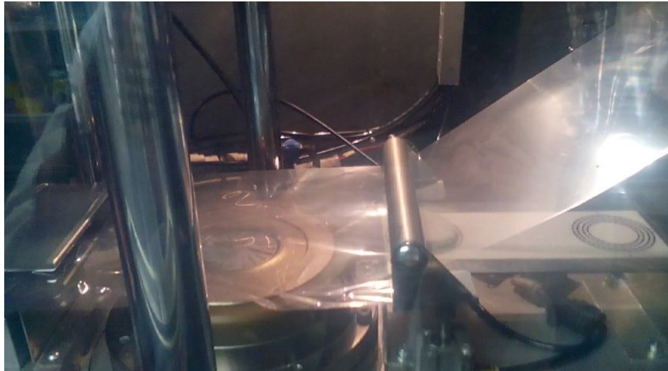
Obrázek 59 – Vzorek vložený ve viskozimetru
