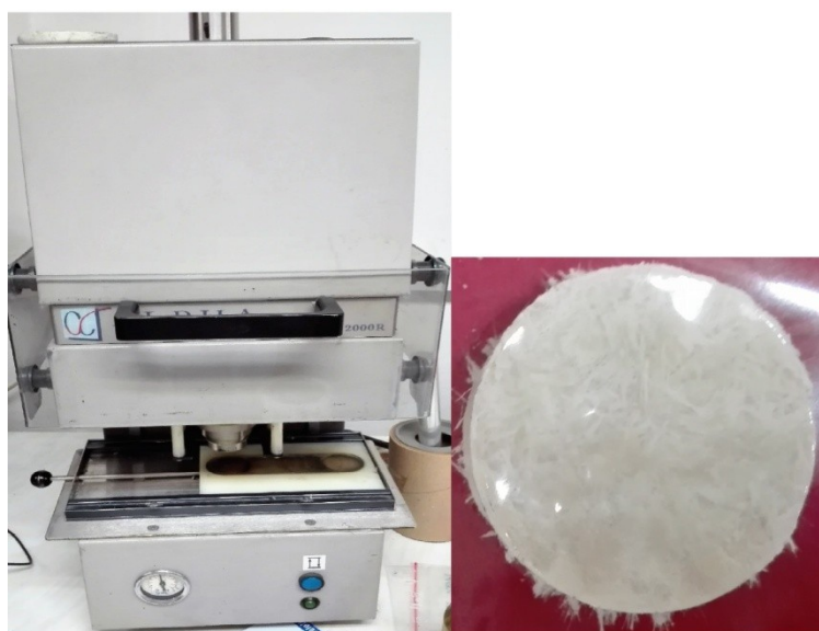
Obr. 21 – Zařízení pro vysekávání koleček a vyseknuté kolečko
