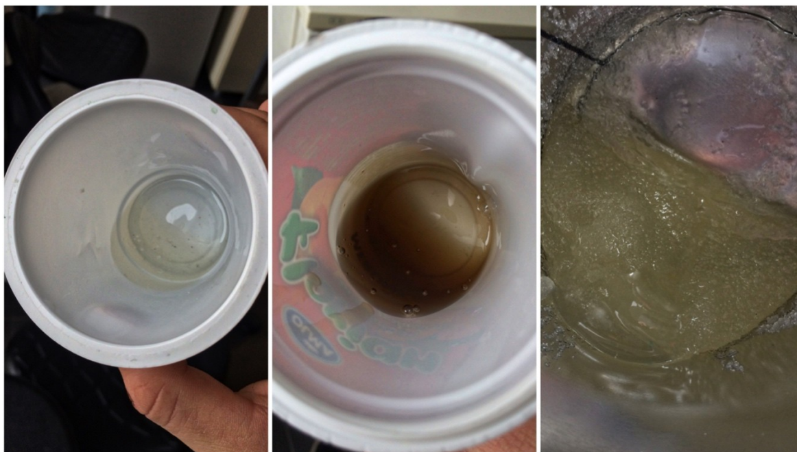
Obr. 17. Rozpuštěné kaučuky (zleva – HNBR, SBR, nanopren) ve styrenu
