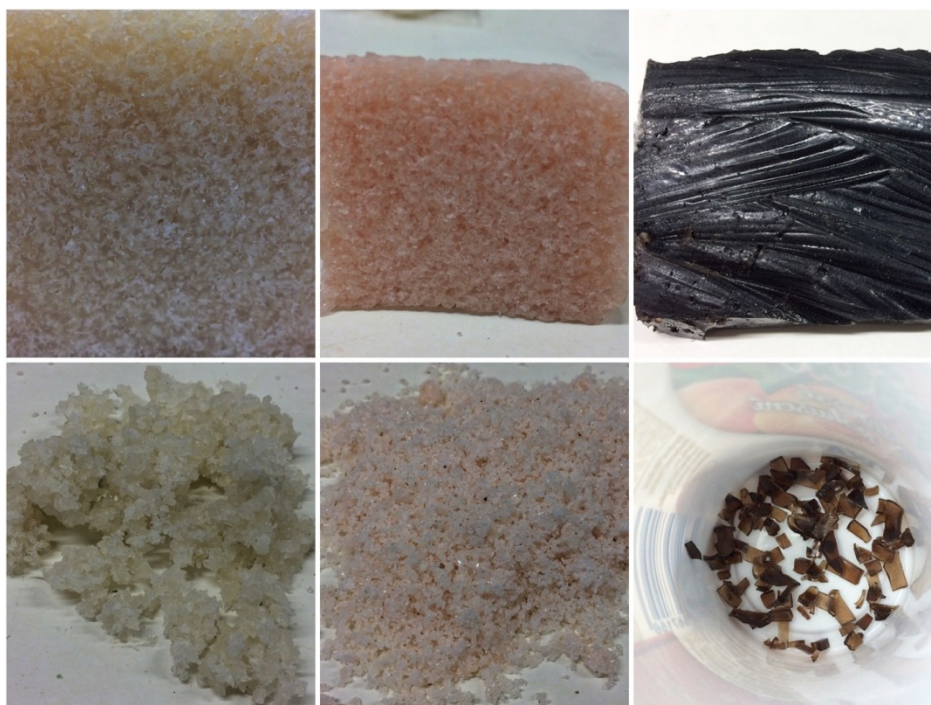
Obr. 16. Na obrázku HNBR, nanopren a SBR (zleva). Obrázky v druhé řadě odpovídají kaučukům po drcení.
