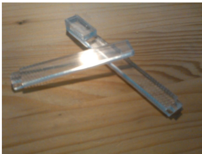
Obr. 31 - přetržený spoj PMMA+PMMA
