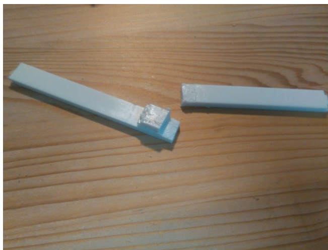
Obr. 39 - přetržený spoj PBT+PBT
