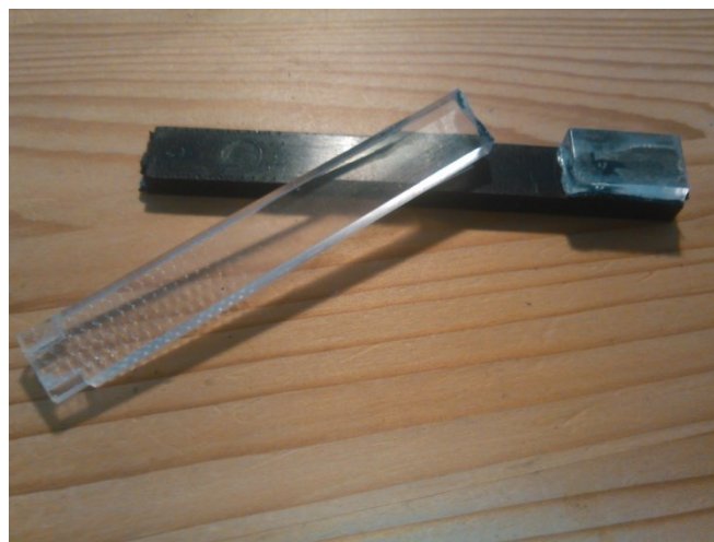
Obr. 27 - přetržený spoj ABS+PMMA
