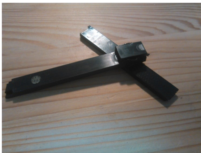
Obr. 35 - přetržený spoj PA+PA
