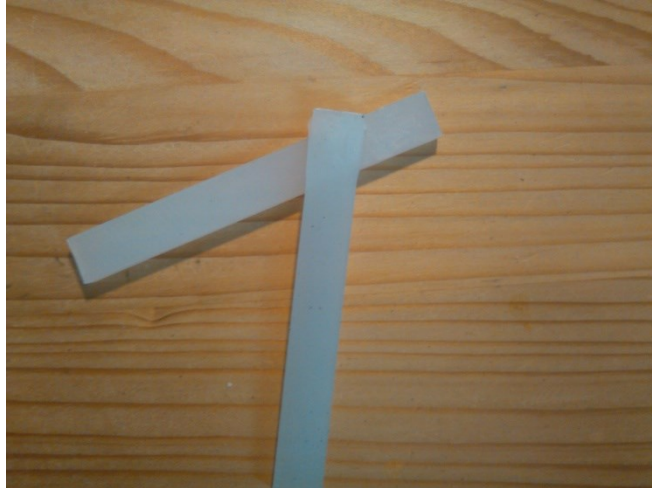
Obr. 41 - přetržený spoj LDPE (n)+LDPE(n)
