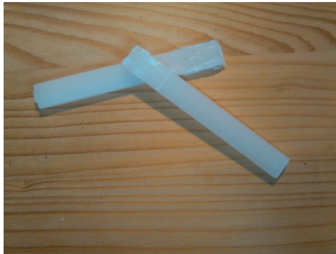
Obr. 29 - přetržený spoj PP+PP
