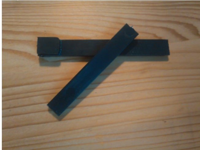
Obr. 33 - přetržený spoj ABS+ABS
