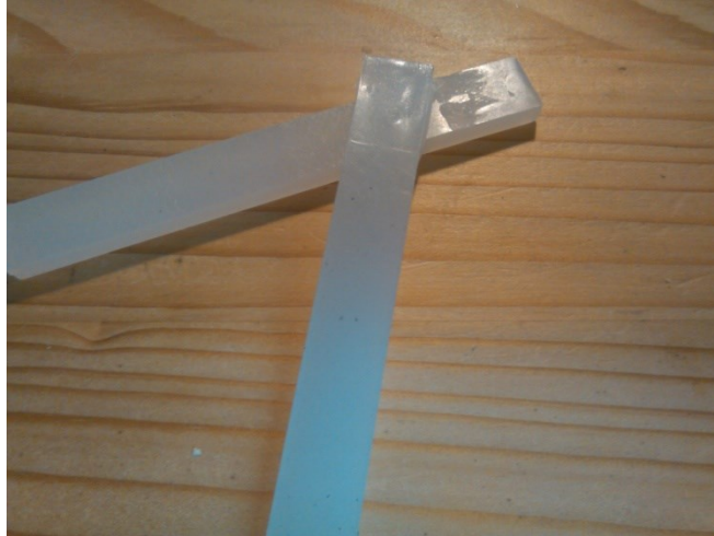
Obr. 37 - přetržený spoj LDPE(o)+LDPE(o)
