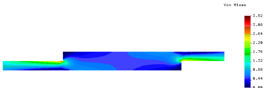
Obr. 48 - von Misesovo srovnávací napětí při zatížení spoje v tahu - přesah 50 mm
