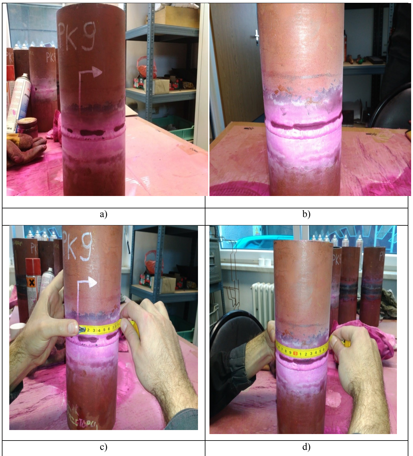
Obr. 4.29 Kapilárna skúška vzorky PK9: a), b) vyvolávanie penetrantu, c), d) meranie veľkosti a polohy indikácie
