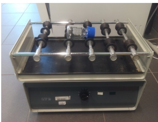
Obr. 14: Použité třepací zařízení s umístěným roztokem polymeru
