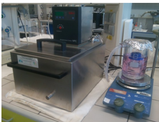
Obr. 15: Použitá temperační lázeň na magnetickém míchadle s roztokem polymeru
