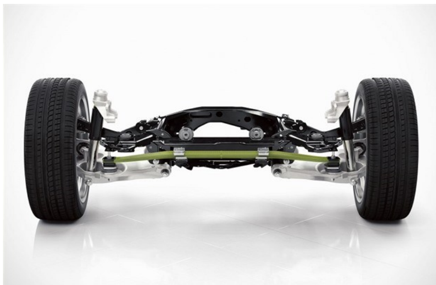
Obr. 4. Zadní příčná kompozitní listová pružina Volvo XC90 [4]
