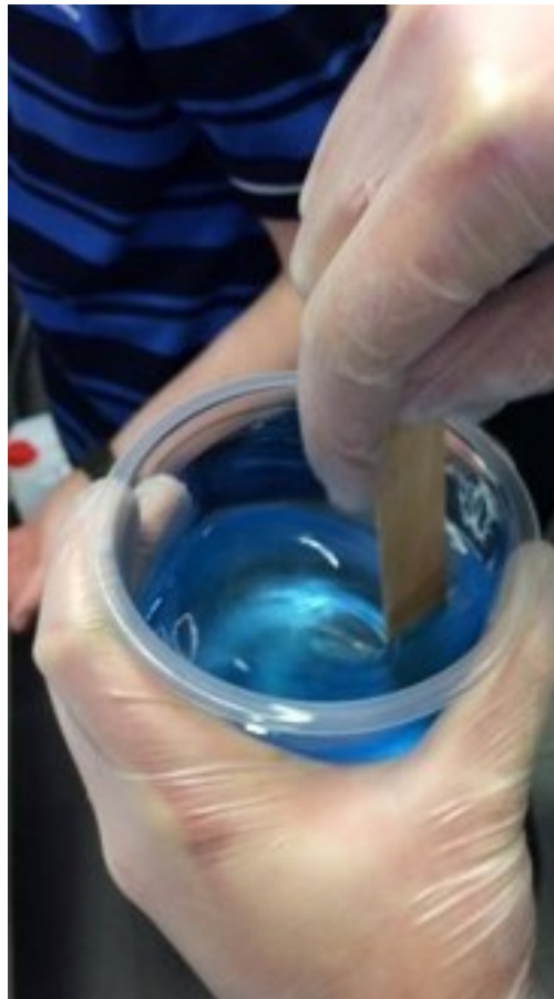
Obr. 26. Míchání epoxidové pryskyřice a tužidla.
