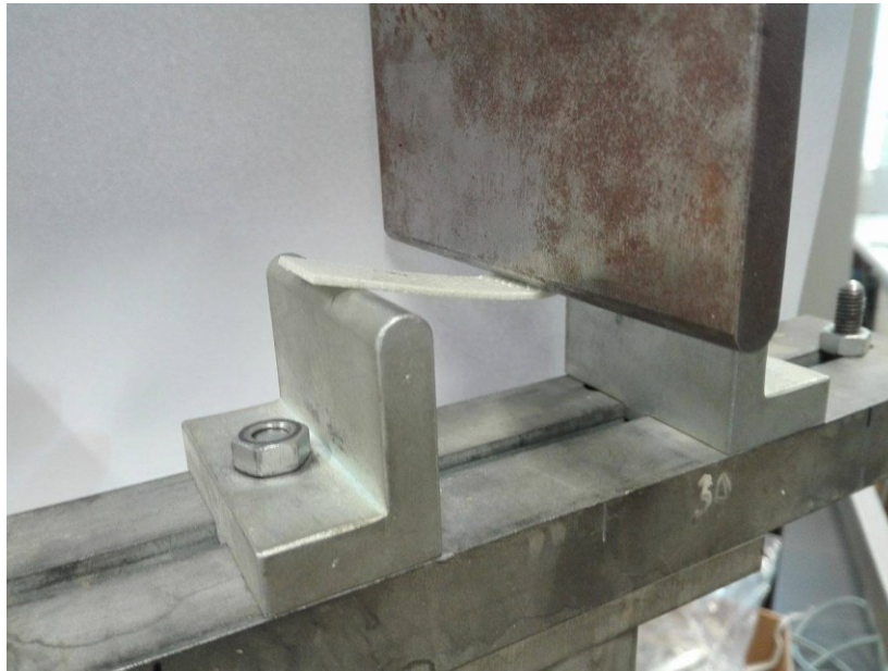
Obr. 30. Průběh statické zkoušky ohybem
