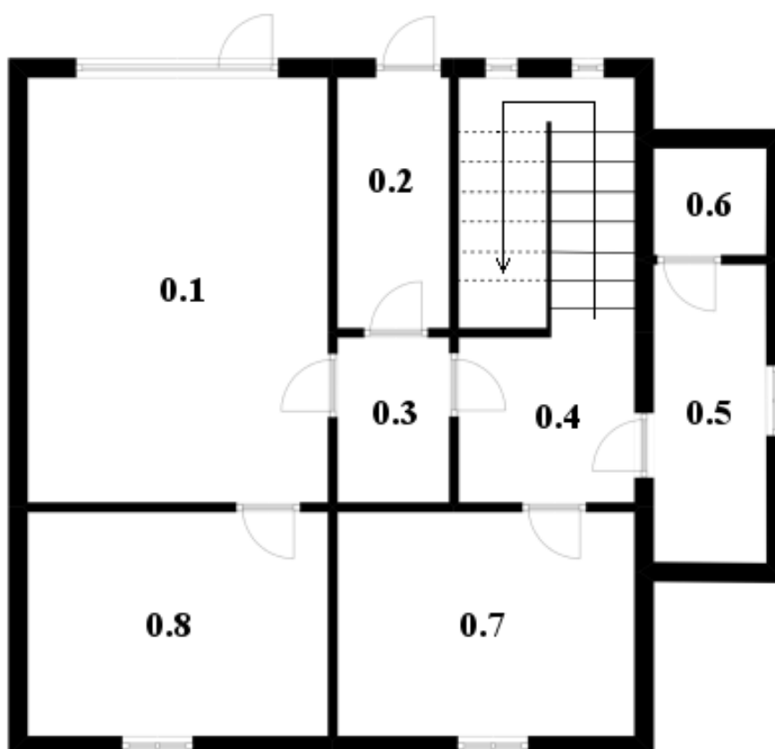
Obr. 32. Půdorys sklepního prostoru
