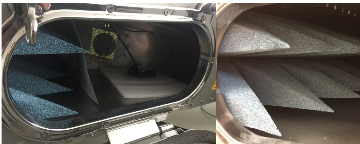
Obr. 7. Otvor a detail absorbérů GTEM cely
