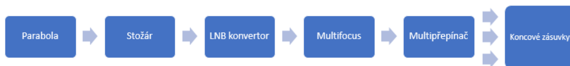
Obr. 33. Blokové schéma zapojení DVB-S/S2 pro bytový dům
