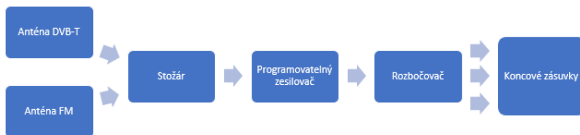
Obr. 25. Blokové schéma zapojení DVB-T/T2 pro bytový dům
