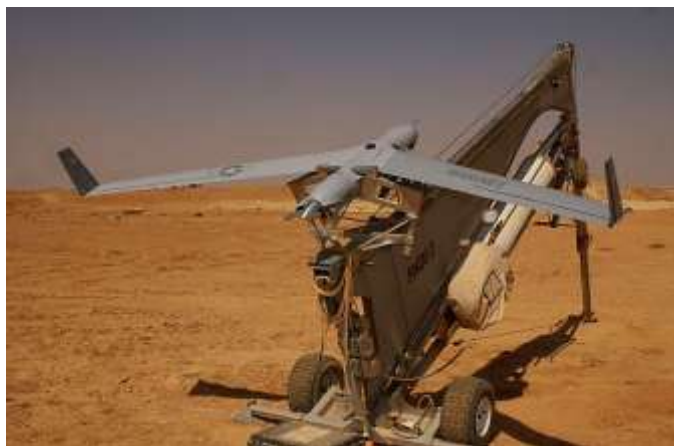
Obr. 19. Letoun ScanEagle na startovacím katapultu SuperWedge [57]
