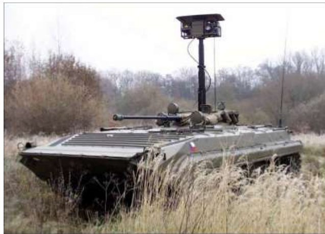
Obr. 9. Dělostřelecký průzkumný komplet LOS-M [46]
