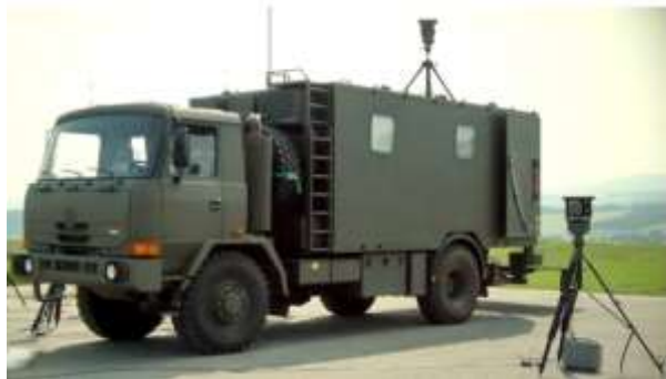
Obr. 12. Systém ostrahy a monitorování SOM [50]
