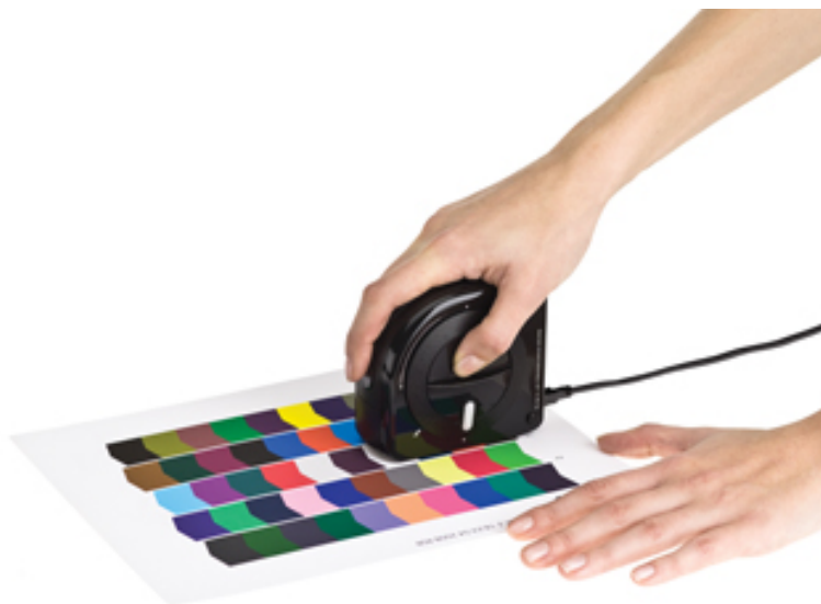
Obrázok 15: Kalibrácia farieb tlačiarne pomocou sondy [25]
