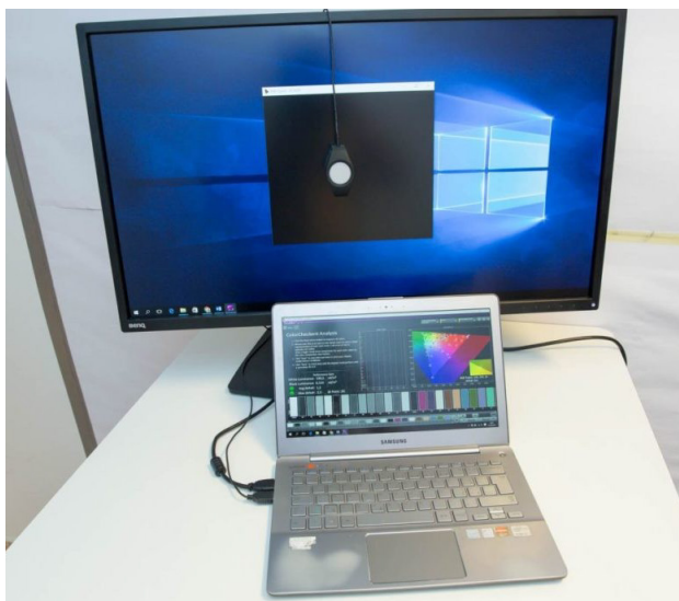
Obrázok 14: Kalibrácia monitoru pomocou sondy [24]
