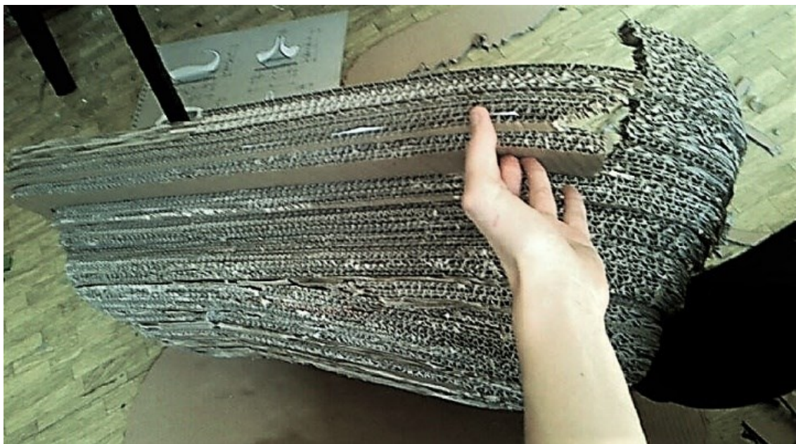
Obr. 64. Ukázka 3cm lemu s nosnou funkcí roštu pro matraci
