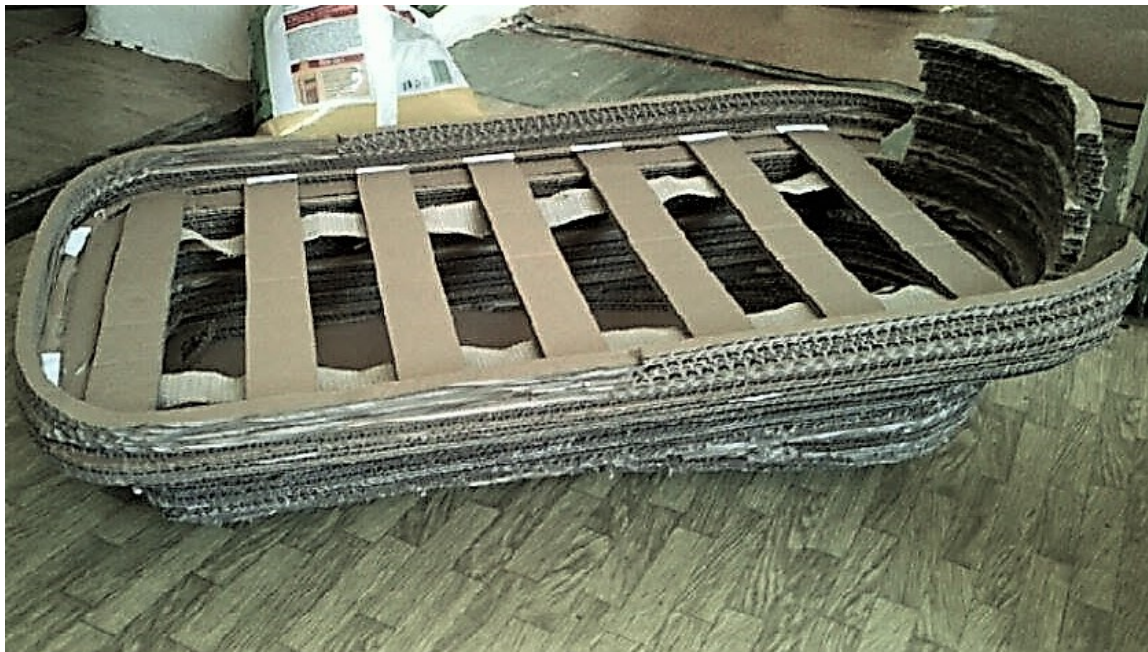
Obr. 63. Model z lepenky 1:1, ukázka 3cm lemu s nosnou funkcí roštu pro matraci
