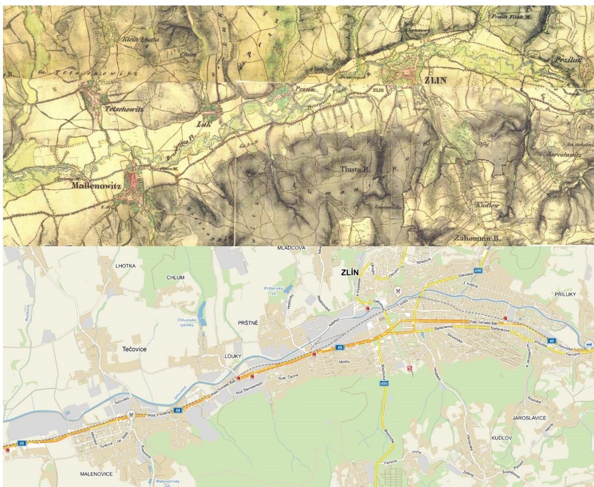
Obr. 11: Porovnání tvaru Dřevnice před a po regulaci
