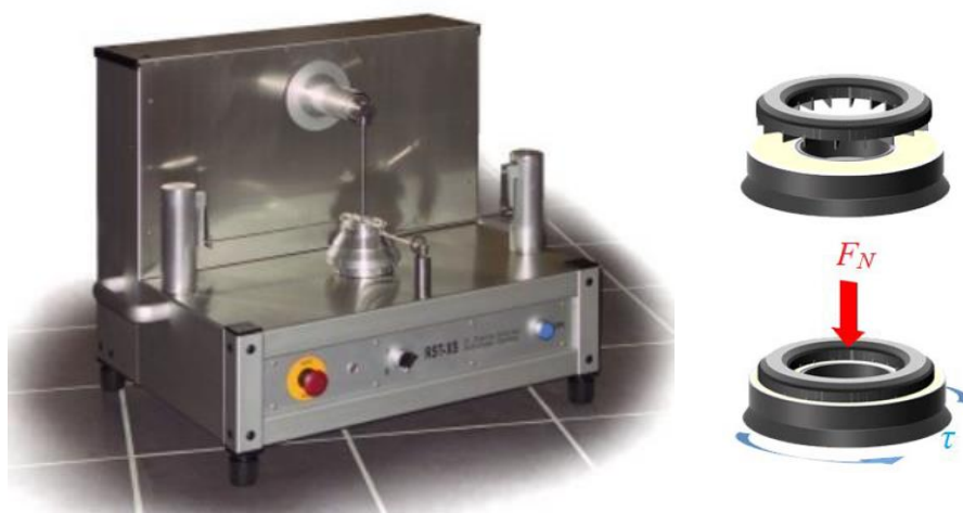
Obr. 33: Schulzův rotační smykový stroj RST-XS [134-135].
