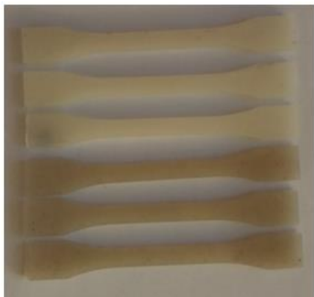
Obr. 37: Testovací tělesa (dogbones) pro tahové zkoušky.
