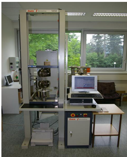
Obr. 38: Univerzální testovací zařízení Zwick 1456, určené pro statické i dynamické (nizkocyklové) zkoušky.
