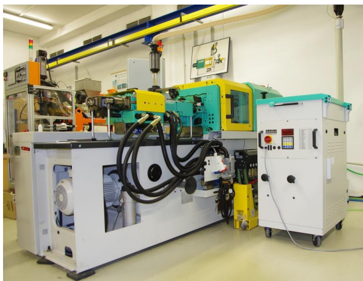
Obr. 36 : Arburg Allrounder 170 U 150: Max. objem materiálu: 10,5 cm 3 ; průměr šneku: 15 mm; uzavírací síla: 150 kN.
