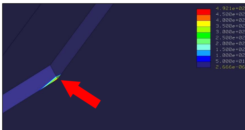
Obr. 5.1: Zobrazení maximální hodnoty namáhání - 492 MPa.
