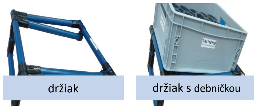
Obrázok 51 Gravitačný držiak na debničky (vlastné spracovanie)
