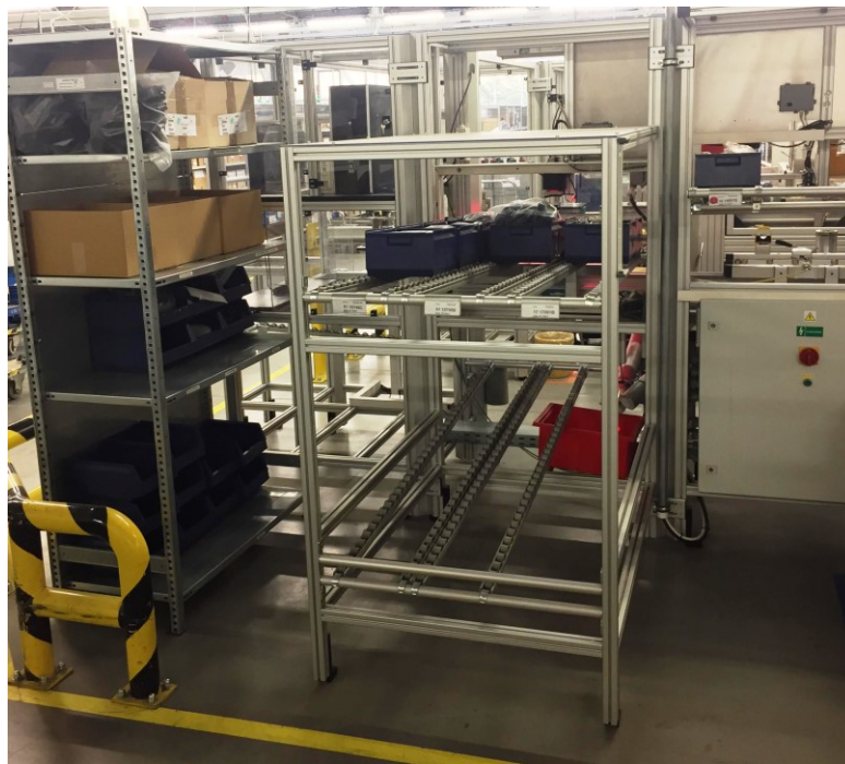
Obrázek 41 Válečkový podavač (vlastní foto)
