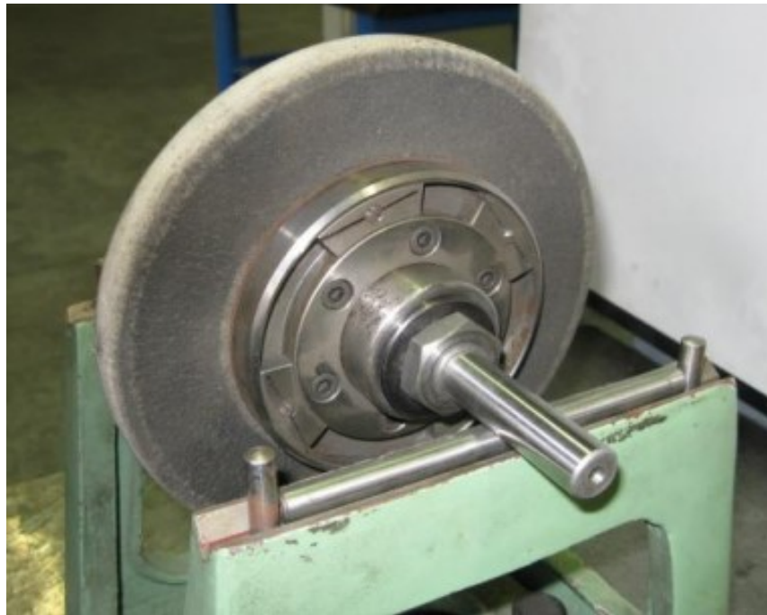
Obrázek 16 Statické vyvažování brusného kotouče na stojánku
